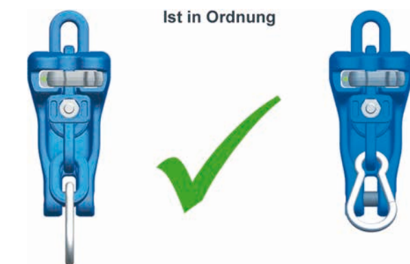
Abbildung 10 – Richtige Montage Stopperset
